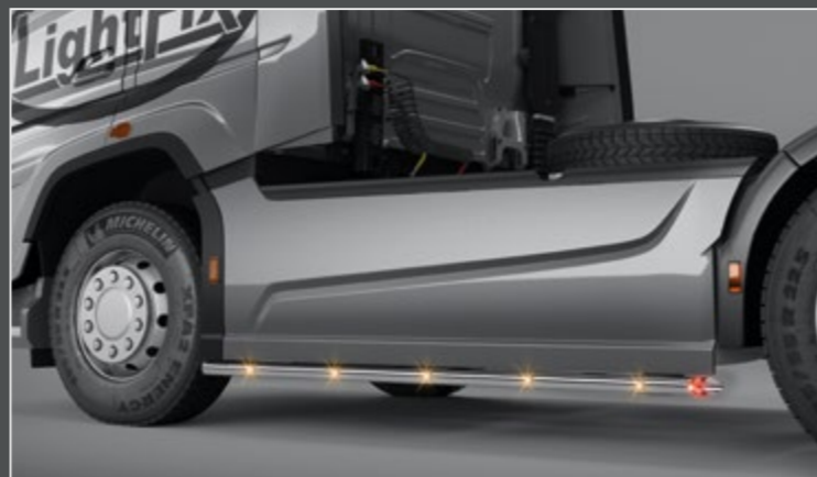
22740-5-P /-B - LightFix - SIDE-LINER Barra laterale (set) in acciaio inossidabile lucidato a mano e verniciato nero Ø 60mm - al 100% predisposto con cablaggio e spina di connessione incl. LED rossi alle estremità del tubo e LED arancioni ai lati
